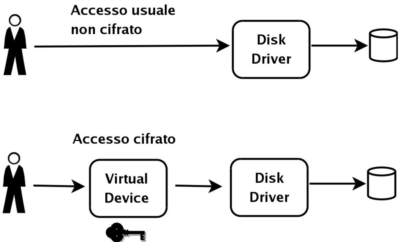
Fig. 1 Accesso diretto e tramite il device virtuale di cifratura
