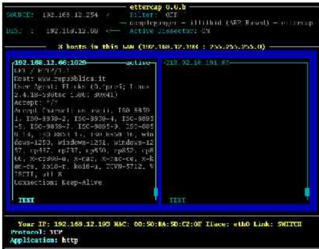
Figura 5. Ettercap rileva solo la richiesta da host ma non i pacchetti di ritorno con i dati della pagina web
