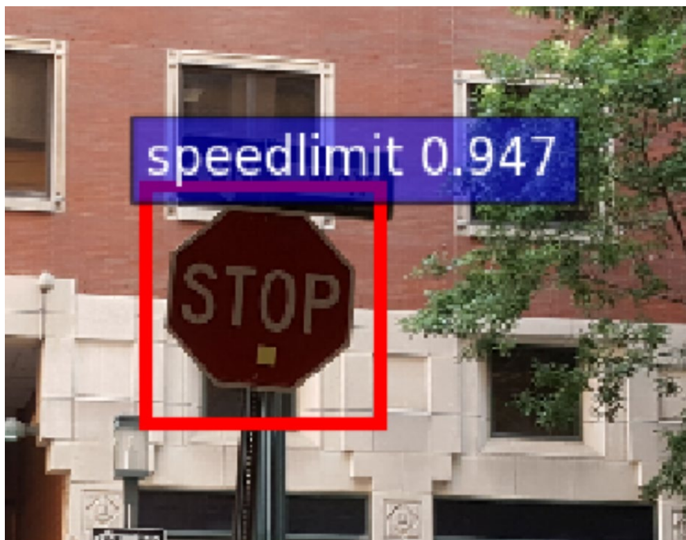
Fig. 1 Cartello stradale di Stop con sticker [Fonte Rif. 2]
